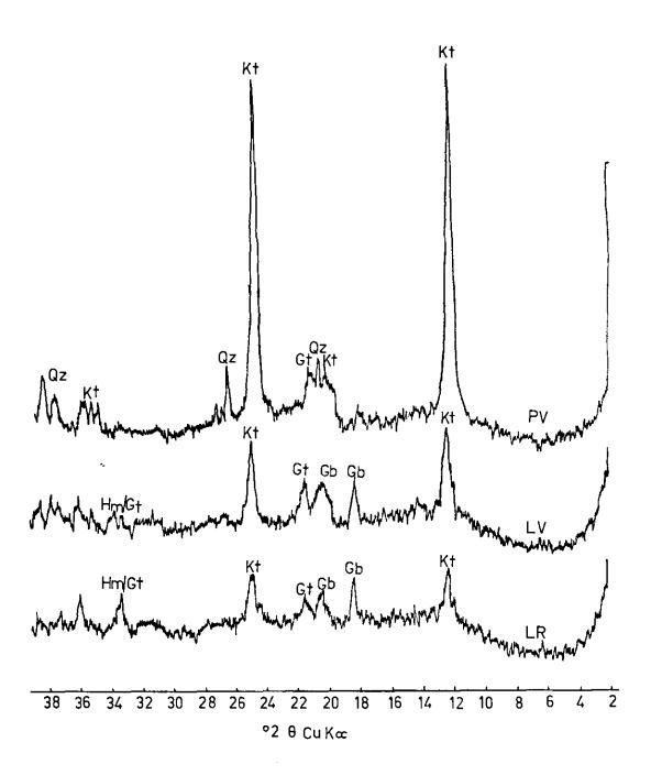
FIG. 2. Difratogramas de raios-X da fração argila dos materiais de solos utilizados. Lavras, MG. 1984.
