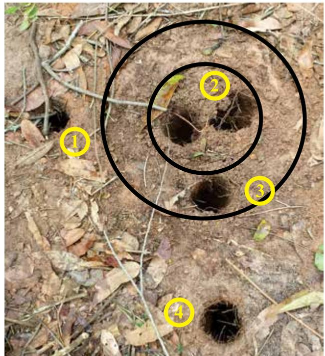
**Figura 2.** Amostragem de solo nas camadas estudadas sob regime hídrico controlado: 1, amostra testemunha ( $K_{\text{test}}$ ); 2, amostra na parte interna do anel interno ( $K_{\text{int}}$ ); 3, amostra na parte externa do anel interno ( $K_{\text{ext}}$ ); e 4, amostra fora do anel externo ( $K_{\text{fora}}$ ).
