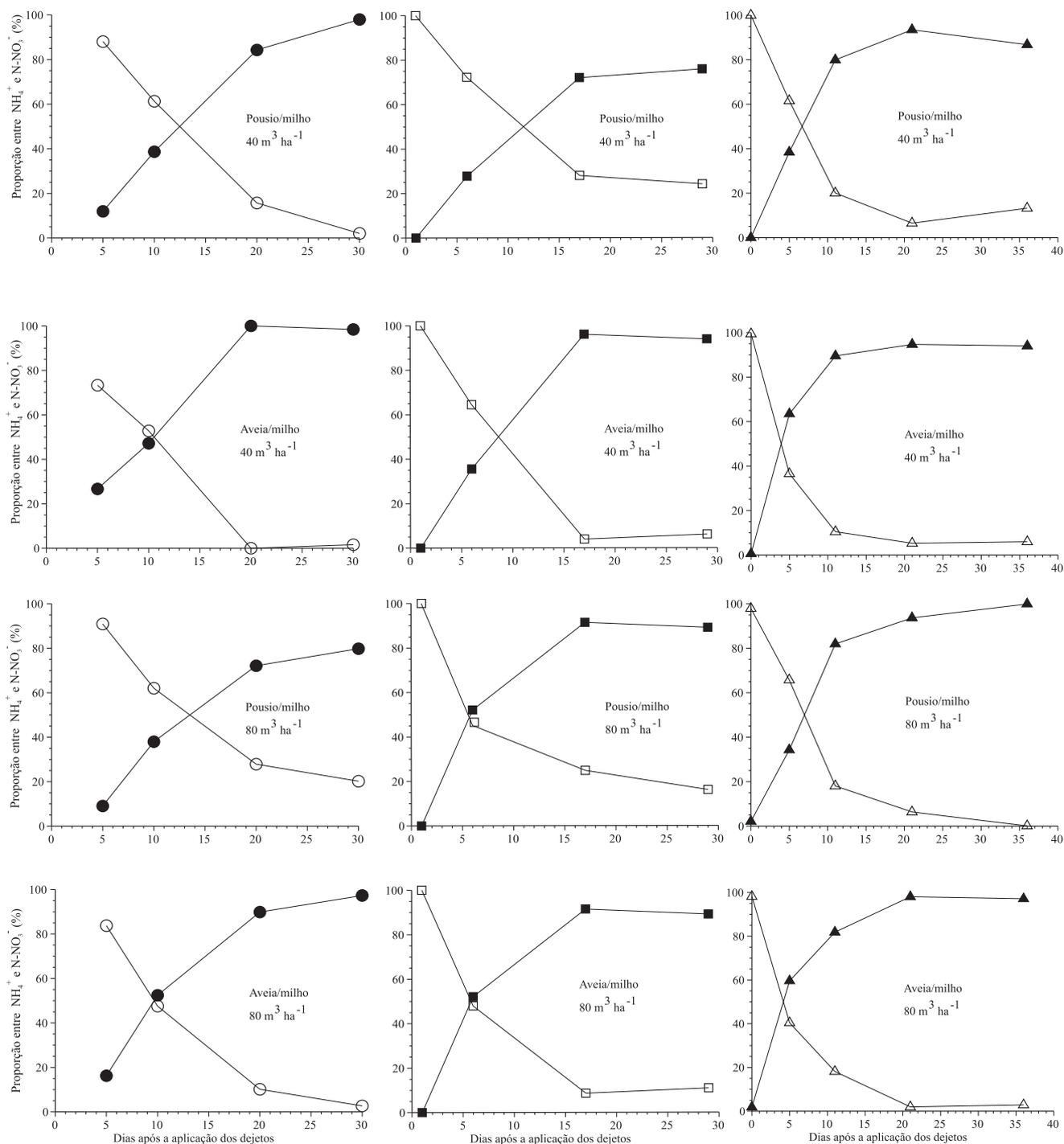
**Figura 2.** Variação temporal na proporção entre  $\text{N-NH}_4^+$  (○, □, △) e  $\text{N-NO}_3^-$  (●, ■, ▲), na camada de 0–60 cm do solo (soma das camadas 0–5, 5–15, 15–30 e 30–60 cm), nos primeiros 36 dias após a aplicação das doses 40 e 80  $\text{m}^3 \text{ha}^{-1}$  de dejetos líquidos de suínos, sobre os resíduos culturais dos sistemas aveia/milho e pousio/milho, em 1998 (círculo), 1999 (quadrado) e 2000 (triângulo).
